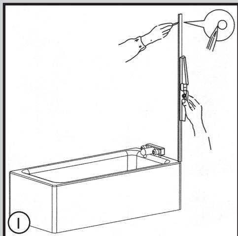
Après avoir libéré le profilé mural "A" de l'écran "B", positionner le profilé à la verticale le long du mur à l'aide d'un niveau. Le profilé doit reposer sur le bord de la baignoire, 1 ou 2 cm à l'intérieur. Tracer les emplacements de fixation.
