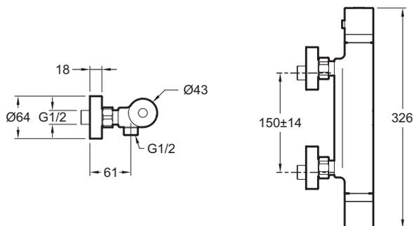
Descriptif CCTP : Mitigeur thermostatique douche mural. E24324. Collection : RIVOLI. MATÉRIAU : N/A. TYPE D'INSTALLATION : Mural. TYPE : Mitigeur. DÉBIT (L/MN SOUS 3 BARS) : 12 l/mn. RACCORDS : Avec raccords et rosaces murales. MÉCANISME : Cartouche thermostatique. ENTRAXE (MM) : 150±14. MITIGEUR DE DOUCHE : Thermostatique. BUTÉE DE SÉCURITÉ : 37°C. TEMPÉRATURE MAXI : 50°C. CORPS TIÈDE : Oui. GARANTIE MÉCANISME : 5 ans. GARANTIE FINITION : 10 ans.
