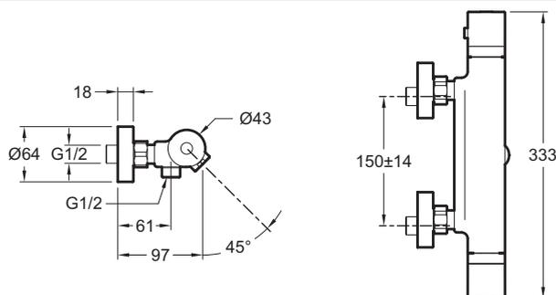
Descriptif CCTP : Mitigeur thermostatique bain-douche mural. E24325. Collection : RIVOLI. MATÉRIAU : N/A. TYPE D'INSTALLATION : Mural. TYPE : Mitigeur. DÉBIT (L/MN SOUS 3 BARS) : 22 l/mn (bain) et 12 l/mn (douche). RACCORDS : Avec raccords et rosaces murales. MÉCANISME : Cartouche thermostatique. TYPE DE BEC : Intégré. MITIGEUR DE BAIN : Thermostatique. BUTÉE DE SÉCURITÉ : 37°C. TEMPÉRATURE MAXI : 50°C. CORPS TIÈDE : Oui. GARANTIE MÉCANISME : 5 ans. GARANTIE FINITION : 10 ans.
