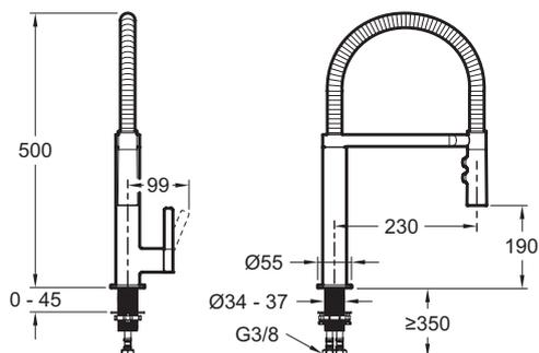
Descriptif CCTP : Mitigeur évier - douchette extractible. E23310. Collection : SPIRALE. DIMENSIONS : 12,70 x 21,50 cm. MATÉRIAU : N/A. TYPE D'INSTALLATION : 1 trou. TYPE : Mitigeur. DÉBIT (L/MN SOUS 3 BARS) : 7 l/mn. HAUTEUR TOTALE DU ROBINET (MM) : 448. SAILLIE DU BEC (MM) : 230. RACCORDS : Avec flexibles d'alimentation. MÉCANISME : Cartouche à disques céramique. TYPE D'INSTALLATION : 1 trou.
