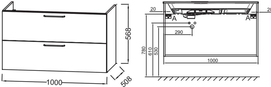
Descriptif CCTP : Meuble sous plan-vasque 100 cm, 2 tiroirs. EB2524-RX. Collection : ODÉON RIVE GAUCHE. DIMENSIONS : 100 x 50,80 x 56,80 cm. POIDS : 36,7 kg. MATÉRIAU : Laque ou mélaminé. TYPE D'INSTALLATION : Suspendu.
